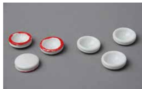
集緒器 直径2cm 中央に小さな孔が開いています。数本の繭糸はこの孔を通して1本の生糸になりました。
