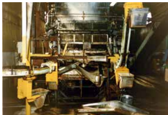
煮繭機前部とコンベア 昭和56年頃 煮繭は、自動配繭機で繰糸工場まで運ばれました。
