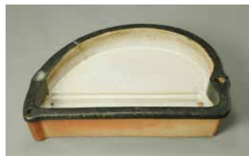
座繰り機の釜 幅59.5cm×高さ12cm×奥行41.5cm
