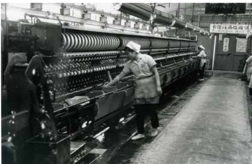
自動繰糸機 昭和50年代 索緒された繭が給繭バスケットに入れられて、一定の間隔でコンベアーで運ばれ自動で補給されました。繰糸作業も自動化され、女工さんは写真手前から奥までの1列を2人で担当しました。
