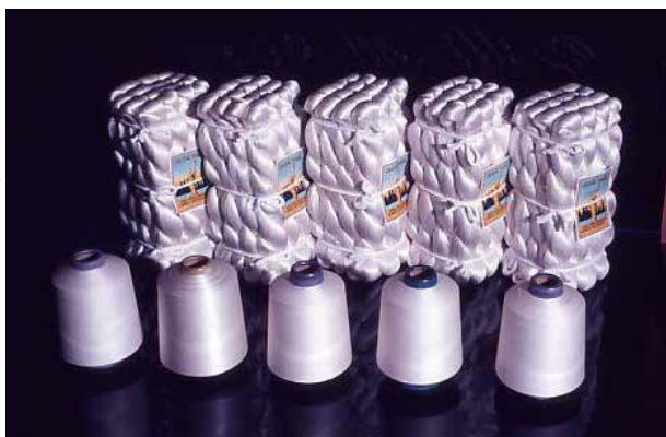
コーン巻き撚糸（手前）と括造り生糸（短手） 撚糸を巻き取る形がコーン（とうもろこし）に似ているところから名づけられました。機屋で経糸に使いました。
